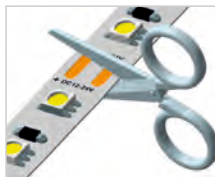
Отрежьте светодиодную ленту в месте для резки
