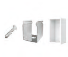
Монтажная клипса из нержавеющей стали и заглушка светильника. 8x12.1x7.7мм (ДxШxВ) На каждый метр светильника требуется не менее 3-х клипс
